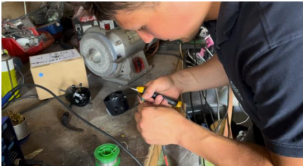
Soudure et pose de gaines thermorétractables
