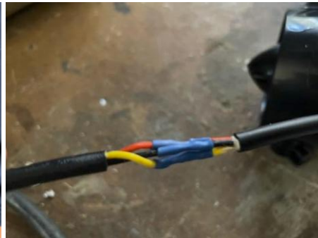
Soudure et pose de gaines thermorétractables
